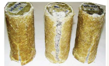
Figure 4 : Faciès de rupture des Eprouvettes en béton confinées par PRFV à 3 plis.
