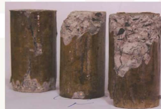
Figure 1 : Eprouvettes en béton sans renforcement après écrasement.
