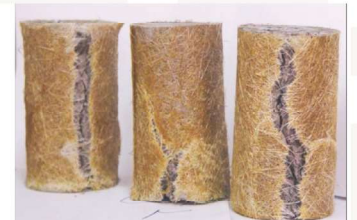
Figure 2 : Faciès de rupture des Eprouvettes en béton confinées par PRFV à 1 pli.
