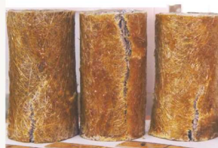
Figure 3 : Faciès de rupture des Eprouvettes en béton confinées par PRFV à 2 plis.
